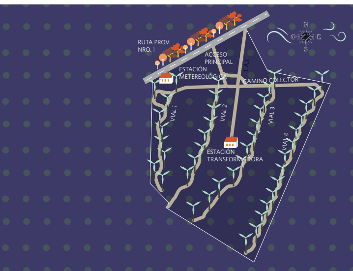
– PLANTA. Disposición de los aerogeneradores.
