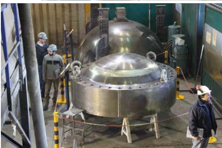
-PRESIÓN. Soportará condiciones de presión, temperatura y radiación durante al menos 40 años de operación.
