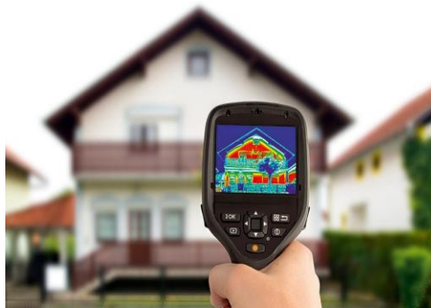
Eficiencia energética - Medición termográfica en viviendas
